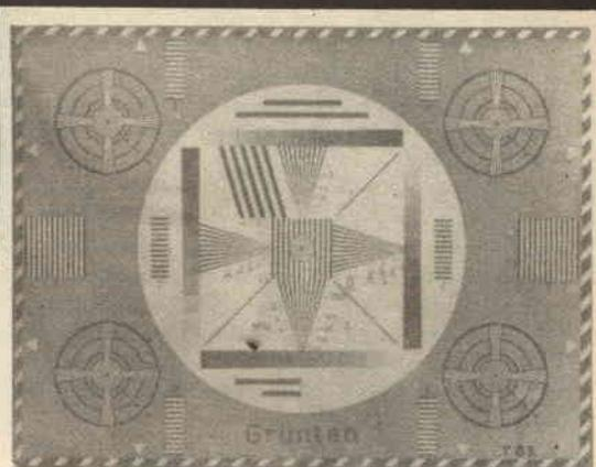
Fig. 3 - Questo è invece il monoscopio della stazione di Grünten, nella Germania federale. Appare raramente, in condizioni di favorevole riflessione da parte degli strati ionosferici.
